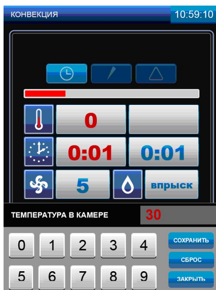
Рис.19 Редактирование параметра « ТЕМПЕРАТУРА В КАМЕРЕ »
